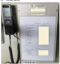
通信衛星 と直接通信する 電話機 を使用した 電話網 を提供するサービスです。 衛星電話は、電線 (現在は 光ケーブル やマイクロ波回線も使う)を使った有線電話(固定電話)や地上の無線通信技術を用いた携帯電話と比較して、通話可能地域が広いほか、地上設備が少ない通信網が技術的には提供できます。携帯電話で通話できない海上でも通話ができ、緊急時には海上保安庁、掖済会病院と連絡をとり非常事態に対処できるようにしております。
