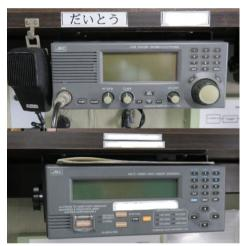
衛星通信技術やデジタル通信技術を利用することによって、モールス信号のような専門的な技術を必要とせず誰でも迅速かつ確実に、遭難・安全通信を行うことを可能にしたシステムです。
